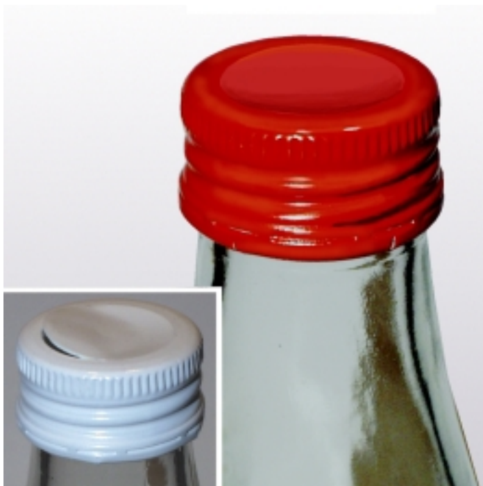
Abb. 1: VACU VENT plus® mit Spiegelritzung. Der steigende Innendruck kann über die Dichtung entweichen. Sind die Abblaswege versperrt (z.B. fest wiederverschlossene Flaschen), öffnet die Spiegelritzung zuverlässig bei 3 - 4 bar und bewahrt die Flasche so vor dem Zerbersten.
